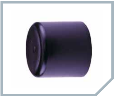
Capac injectat executie lunga PE 100 SDR 11; 10 bar GAZ; 16 bar APA
