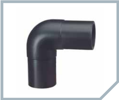
Cot 90°injectat executie lunga PE 100 SDR 17; 5 bar GAZ; 10 bar APA
