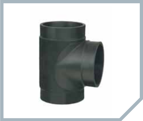
Teu 90° egal injectat executie scurta PE 100 SDR 17; 5 bar GAZ; 10 bar APA
