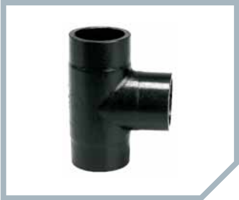
Teu 90° egal injectat executie lunga PE 100 SDR 17; 5 bar GAZ; 10 bar APA
