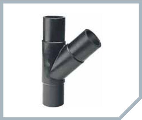
Teu 45° egal injectat executie lunga PE 100 SDR 11; 10 bar GAZ; 16 bar APA
