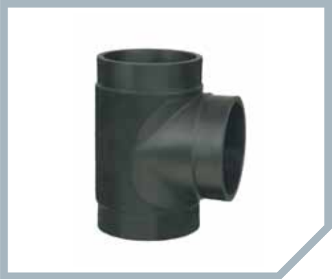
Teu 90° egal injectat executie scurta PE 100 SDR 11; 10 bar GAZ; 16 bar APA
