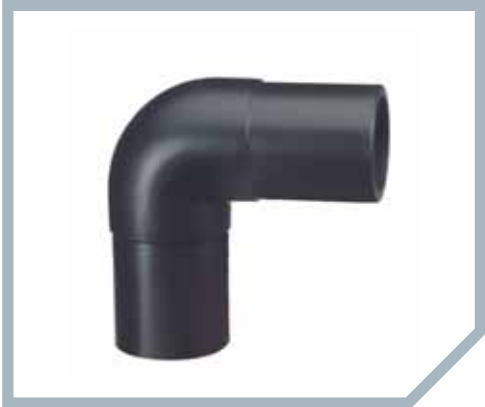
Cot 90° injectat executie lunga PE 100 SDR 11; 10 bar GAZ; 16 bar APA
